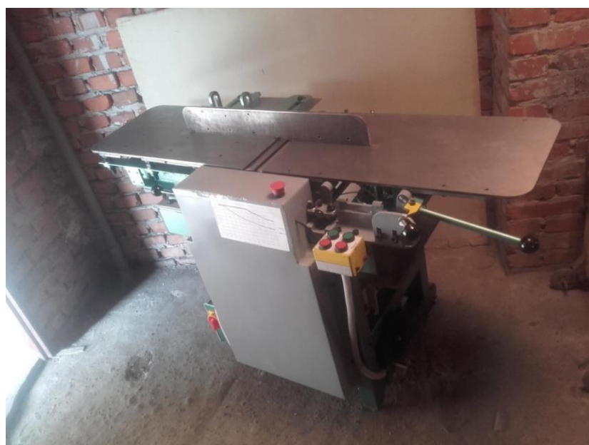
Rysunek 6. Strugarko-grubościówka wykonana na podstawie modelu.
