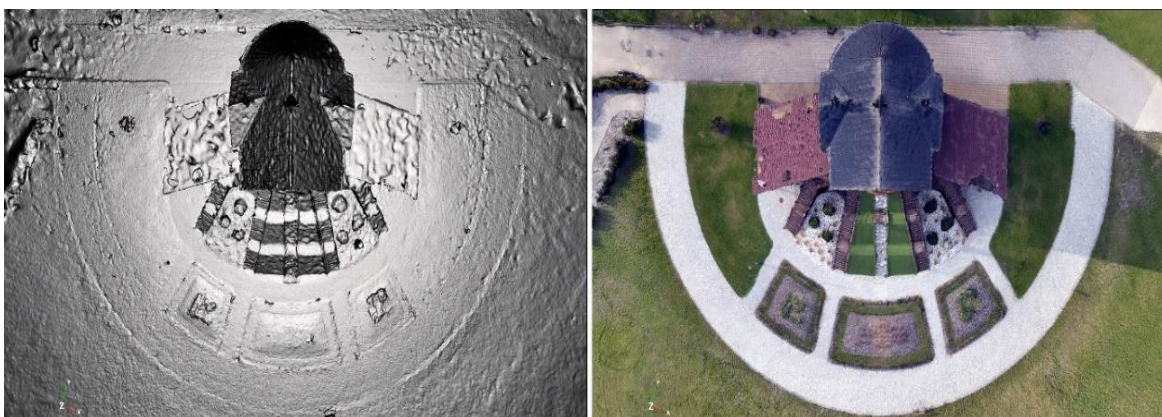
Rysunek 6. Porównanie siatki nieteksturowanej oraz siatki z nałożonymi teksturami. Źródło: opracowanie własne.
