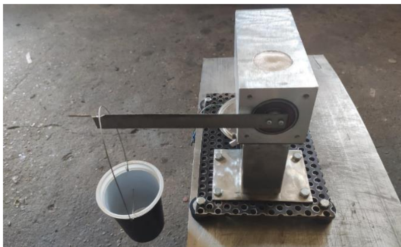
Rysunek 4. Przygotowanie eksperymentu wyznaczania minimalnego momentu obrotowego. Źródło: opracowanie własne.
