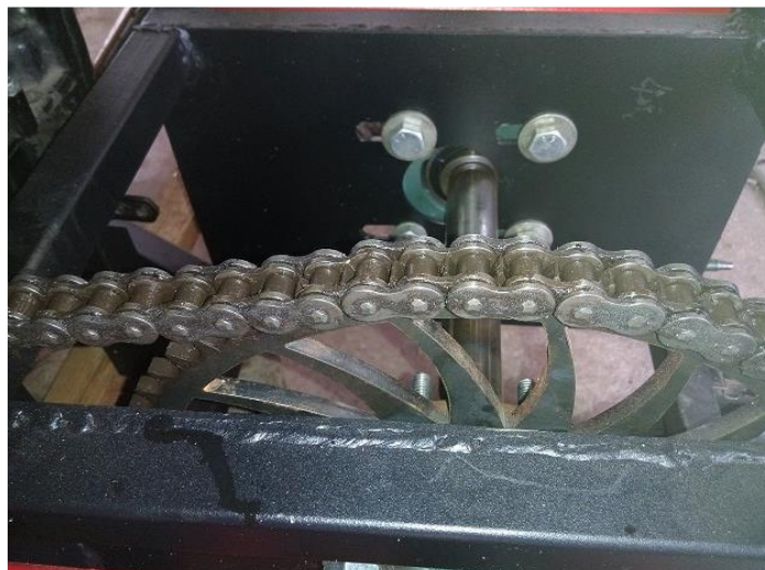
Rysunek 2. Regulacja naciągu łańcucha. Źródło: opracowanie własne.
