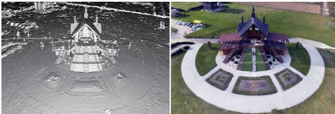
Rysunek 5. Porównanie siatki nieteksturowanej oraz siatki z nałożonymi teksturami. Źródło: opracowanie własne.
