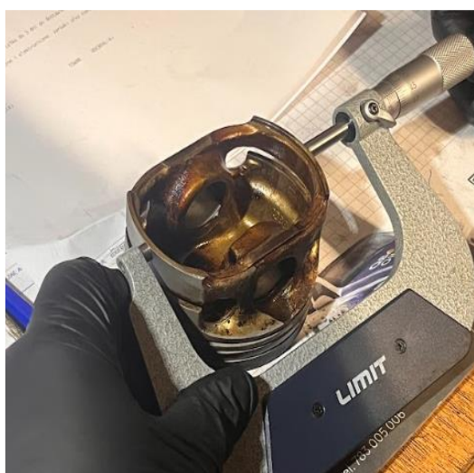
Rysunek 2. Miejsce dokonania pomiarów na płaszczu tłoka.
