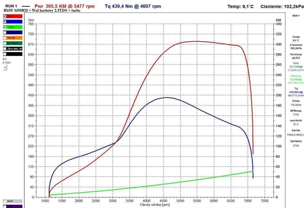
Rysunek 4. Wykres mocy i momentu obrotowego badanego silnika.
