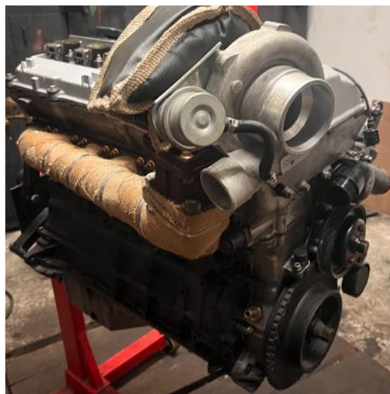
Rysunek 3. Zamontowana turbosprężarka w modyfikowanym silniku.
