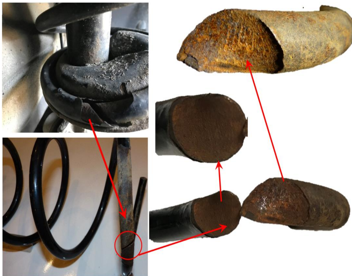
Rysunek 7.58. Pęknięcie zmęczeniowe sprężyny kolumny McPhersona. Źródło: opracowanie własne.
