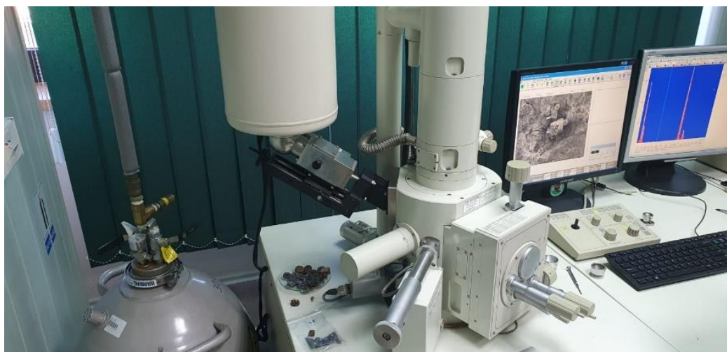
Rysunek 6.6. Stanowisko badawcze wyposażone w skaningowy mikroskop elektronowy JEOL JSM-5510LV.
