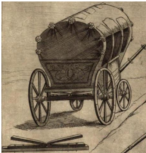
Rysunek 2.2. Widok pierwszego w historii resoru piórowego.
