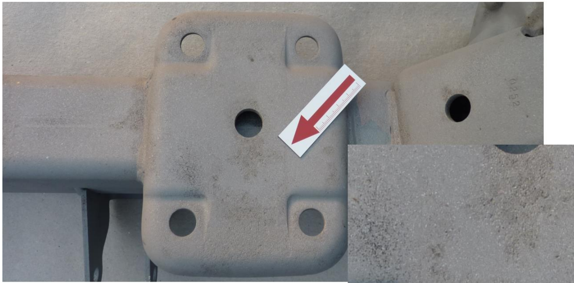
Rysunek 7.7. Przykładowy obraz makrograficzny tylnej belki zawieszenia ze zmienionym profilem powierzchni.
