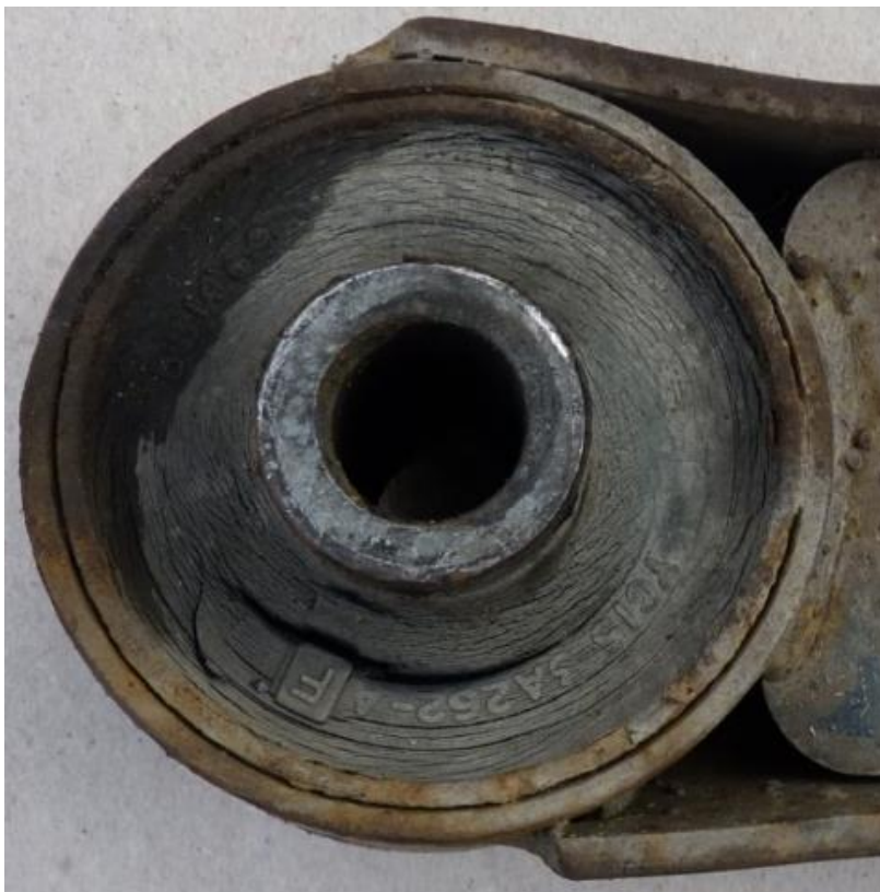
Rysunek 4.8. Przykładowe zużycie tulei metalowo-gumowej. Źródło: opracowanie własne.
