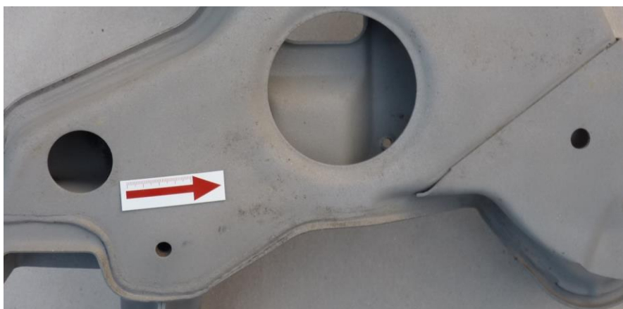
Rysunek 7.9. Obraz makrograficzny miejsc z widocznym odkształceniem plastycznym. Źródło: opracowanie własne.
