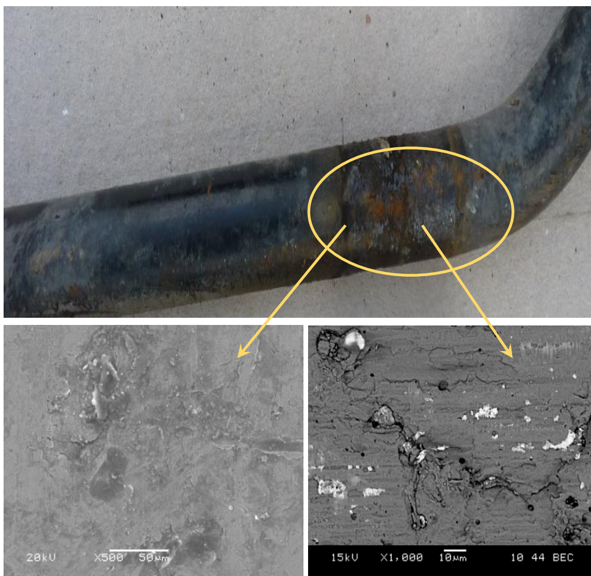
Rysunek 4.3. Przykładowe zużycie drążka stabilizatora przedniego zawieszenia.
